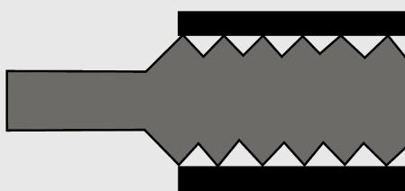
このタイプのカンプロファイルガスケットは、ワンピースの外輪設計を採用しており、外輪により、ガスケットを正しい位置に取り付けることができます。平面座と全平面座フランジに適している。
