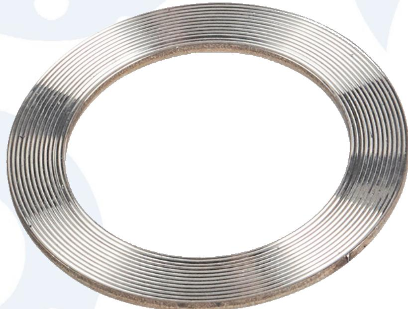
カンプロファイルガスケットは歯付き金属芯を骨格とし、表裏両面に軟質シール材を貼り付けたものです。鋸歯状のデザインは、シール面に応力集中を引き起こすことでシール性能を高め、シール材の横方向の動きも最小限に抑えます。頑丈な金属芯がガスケットの剛性と防爆性を提供します。
