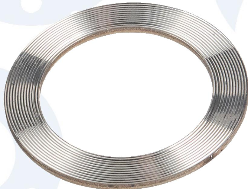
齿形垫片由同心锯齿形实心金属芯为骨架，正反面都贴有柔软的密封材料。锯齿形的设计可以在密封表面引起应力集中来增强密封性能，也最大限度地减少密封材料的横向移动。实心的金属芯能提供垫片的刚性和防爆性。
